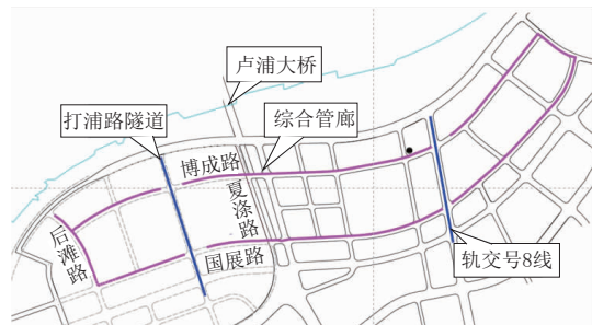
图 1 世博浦东园区综合管廊现状示意图
