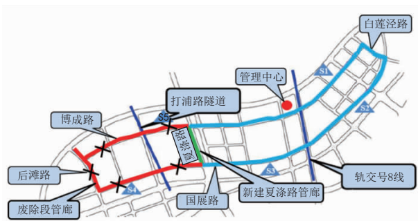
图3 综合管廊改造示意图
