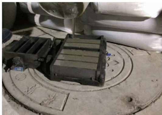
图3 现场制作测试试件
