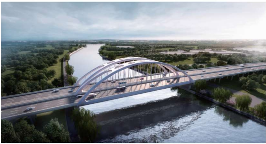
图 3 下承式系杆拱结构
