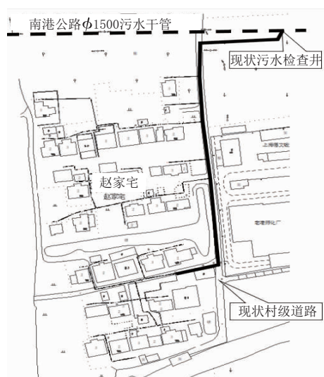
图1 直接纳管模式污水收集系统示意图
