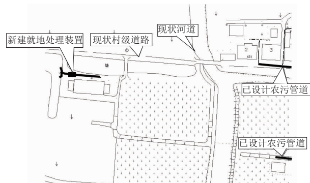
图2 就地模式污水收集系统示意图
