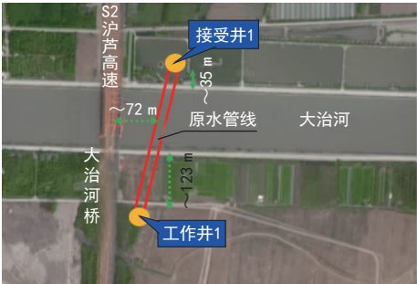
图 2 原水管线穿越大治河处
