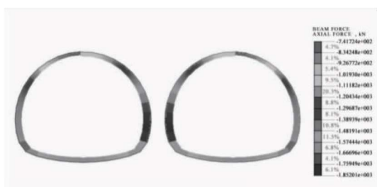
图7 二次衬砌混凝土轴力图
