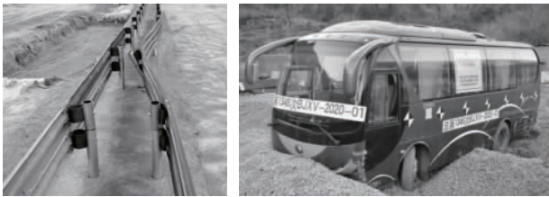
图9 护栏变形及中型客车损坏
