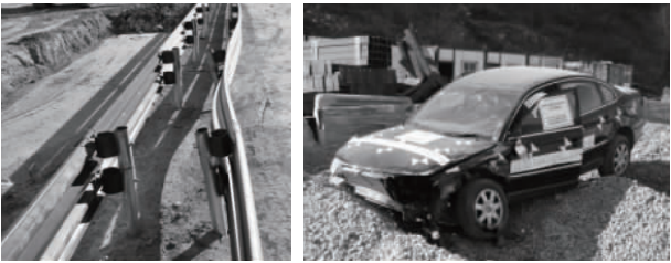
图8 护栏变形及小型客车损坏
