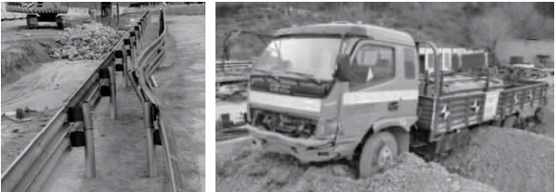
图10 护栏变形及中型货车损坏
