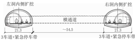
图 8 原位扩建方案总体布置图(单位:m)
