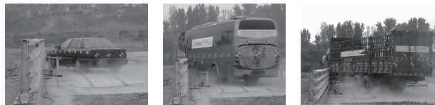
图4 护栏方案实车碰撞试验
