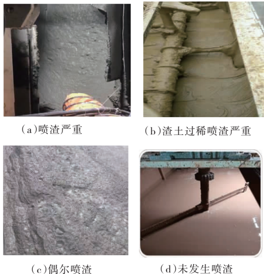
图11 渣土改良试验
