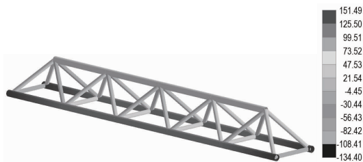
图 4 第一道横撑应力状态图(单位:MPa)
