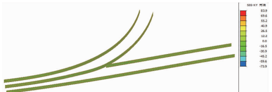
图6 钢梁腹板剪应力(单位:MPa)
