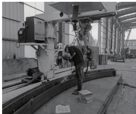
图2 全自动机器人满焊
