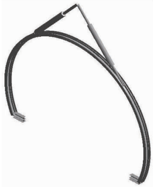
图 3 Ansys Workbench 拱架建模
