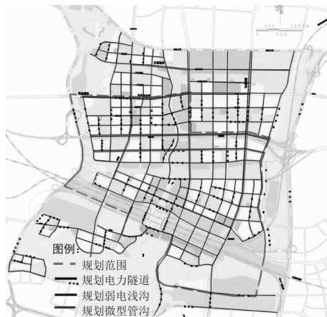
图 17 综合管网系统平面布局图
