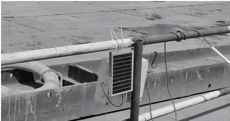
图9 支撑轴力安装示意图 2
