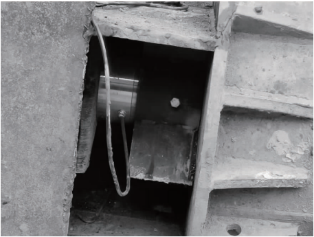
图8 支撑轴力安装示意图 1
