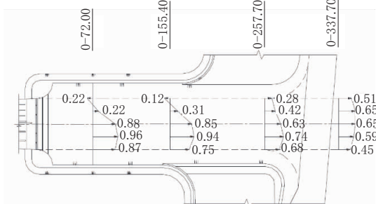
图 19 排涝工况 2 外河垂线平均流速分布(底坎方案三)
