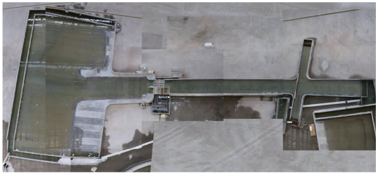
图 7 航塘港泵闸整体水工模型
