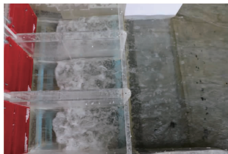
图 9 消能工况下闸室流态
