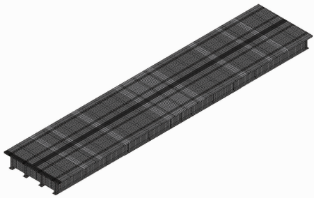
图3 整体预制组合梁有限元模型
