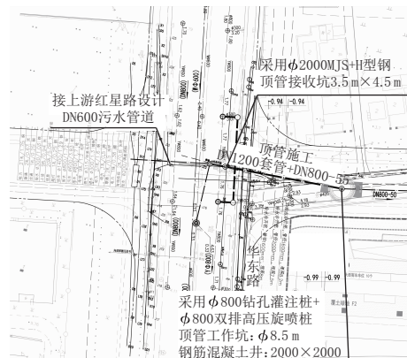
图6 新建顶管接收井方案
