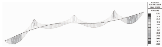
图 17 无网架时,主梁基本组合上缘应力(最大 92 MPa)
