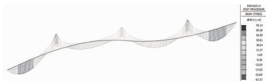
图 16 有网架时,主梁基本组合上缘应力(最大 95 MPa)
