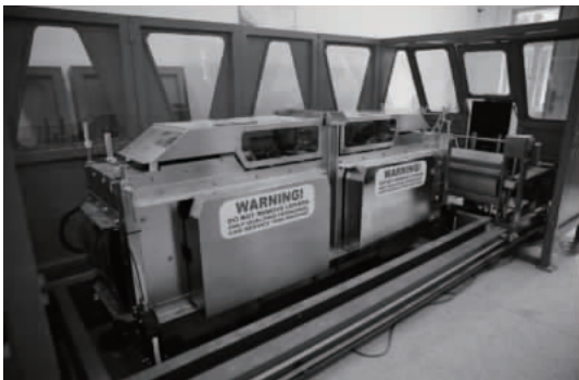
图 2 PAVEMSL11 设备之实景
