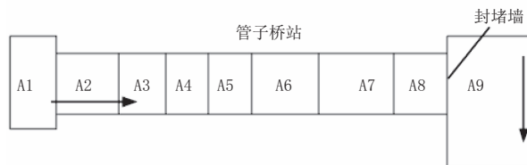
图2 土方开挖顺序示意图
