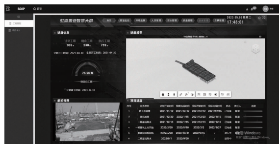
图5 智慧工地平台进度管理模块
