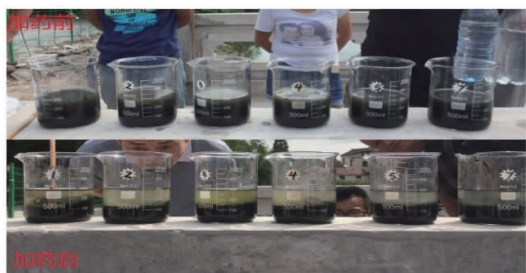
图 13 脱水助剂选型实验
