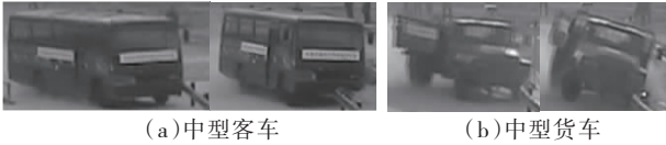
图 6 A 级波形梁护栏实车碰撞试验之实景
