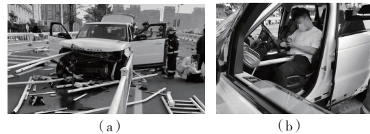
图2 分隔栏构件插入车体时易对乘员形成直接伤害之实景
