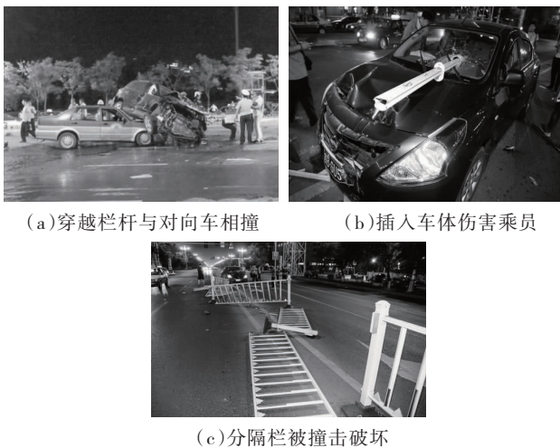
图1 道路分隔栏车辆碰撞事故形态之实景
