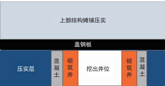
图 4 压实、砌筑分解图
