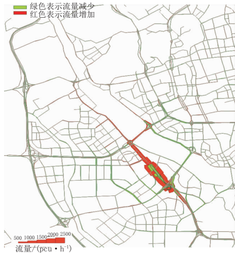
图 18 有无快速化通道至金山大桥对比图(红色为快速化方案)
