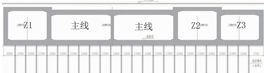
图5 锚杆法横断面示意图
