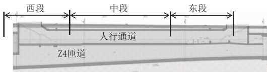
图 11 压重法区段纵断面示意图
