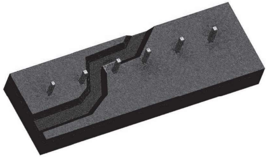
图5 高架桥①8~②3桩基三维模型图
