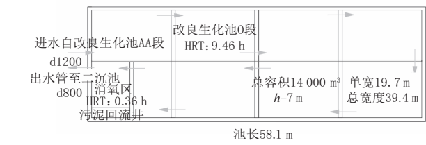
图 4 改良 AAO 生化池 O 段(CASS 池改造)示意图
