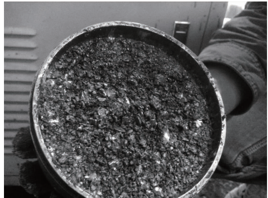
图1 薄饼试件成型
