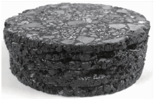
图2 薄饼试件粘接成马歇尔标准试件
