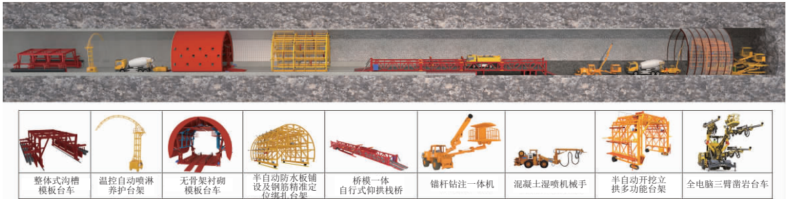
图 1 隧道全工序机械化施工示意
