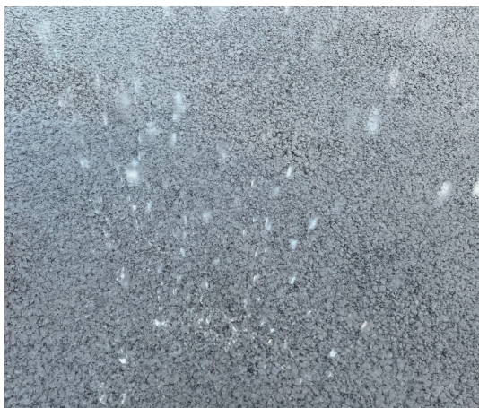
图 5 沥青桥面铺装排水性能
