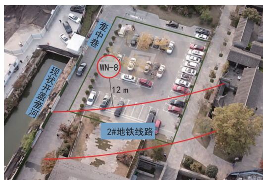
图1 WN-8顶管工作井与地铁2#线平面位置关系
