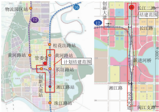
图 12 隧道与地铁结建范围图
