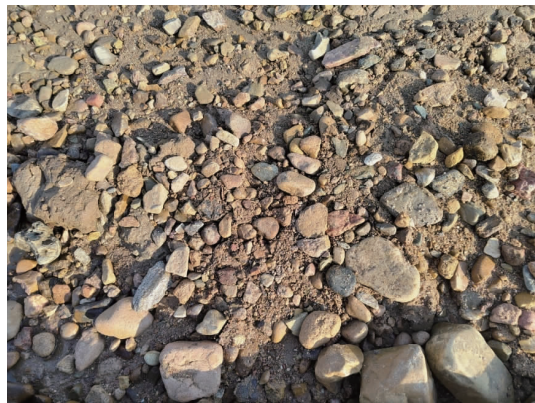
图 11 钢护筒孔底沉渣
