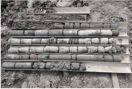
图2 桩顶芯样不成型和桩长不足图
