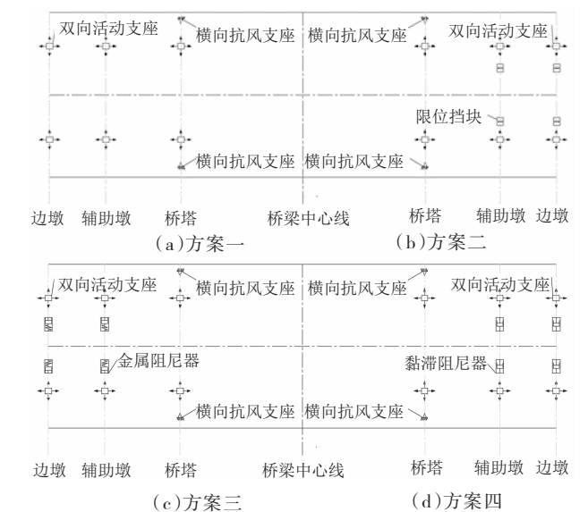
图5 横向限位和减震装置平面布置图
