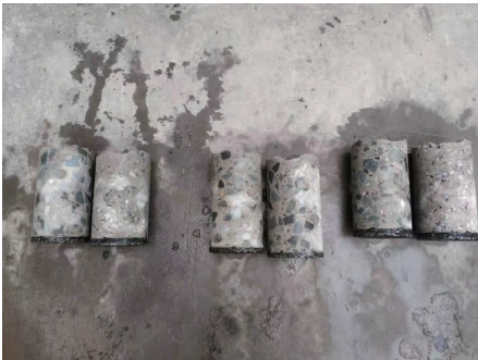
(b)路面芯样取芯实物图
