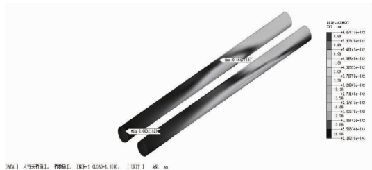
图 8 隧道水平位移极值云图
