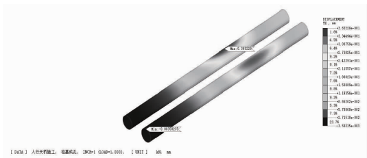
图 9 隧道竖向位移极值云图
