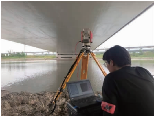
图6 HPQN-X 多点视频动静态位移检测系统
