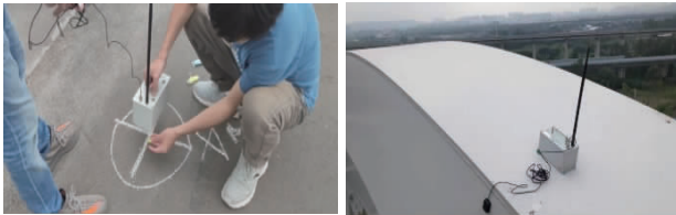
图 5 主梁、拱肋现场实际测点布置
