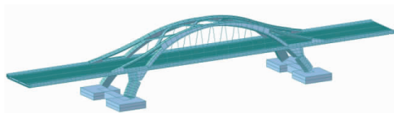
图 9 桥梁有限元模型示意图
