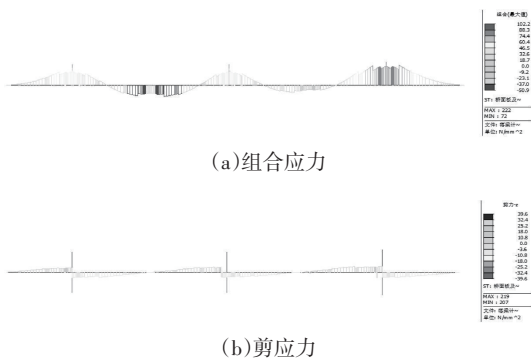
图9 工况2强度计算结果(单位:MPa)
