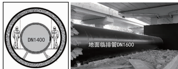
图 2 临时排水示意图(中导管、地面临排管)
