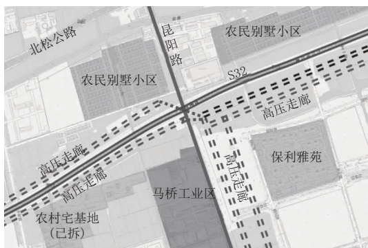
图2 S32沿线高压线和天然气管道分布
