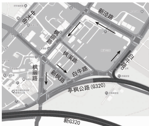
图 4 镇区内部单循环交通流向图
