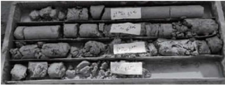
图 2 RJP 工艺取芯芯样
