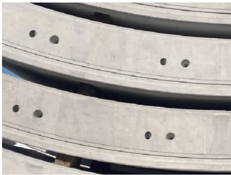
图 2 养护剂养护后的管片表面
