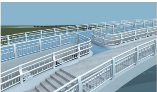
图11 主、次梁上下层链接通道细节设计
