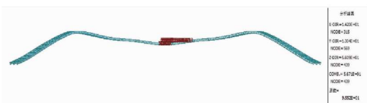
图 17 内侧人行桥活载最大挠度(单位:mm)
