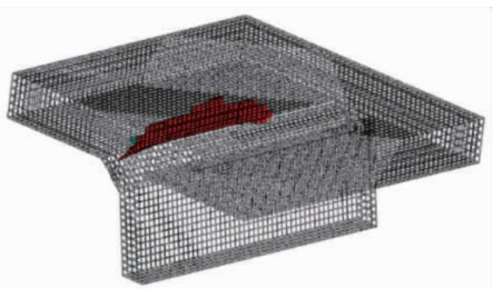
(a) 荷载循环 200 万次裂纹扩展内部拓展图
